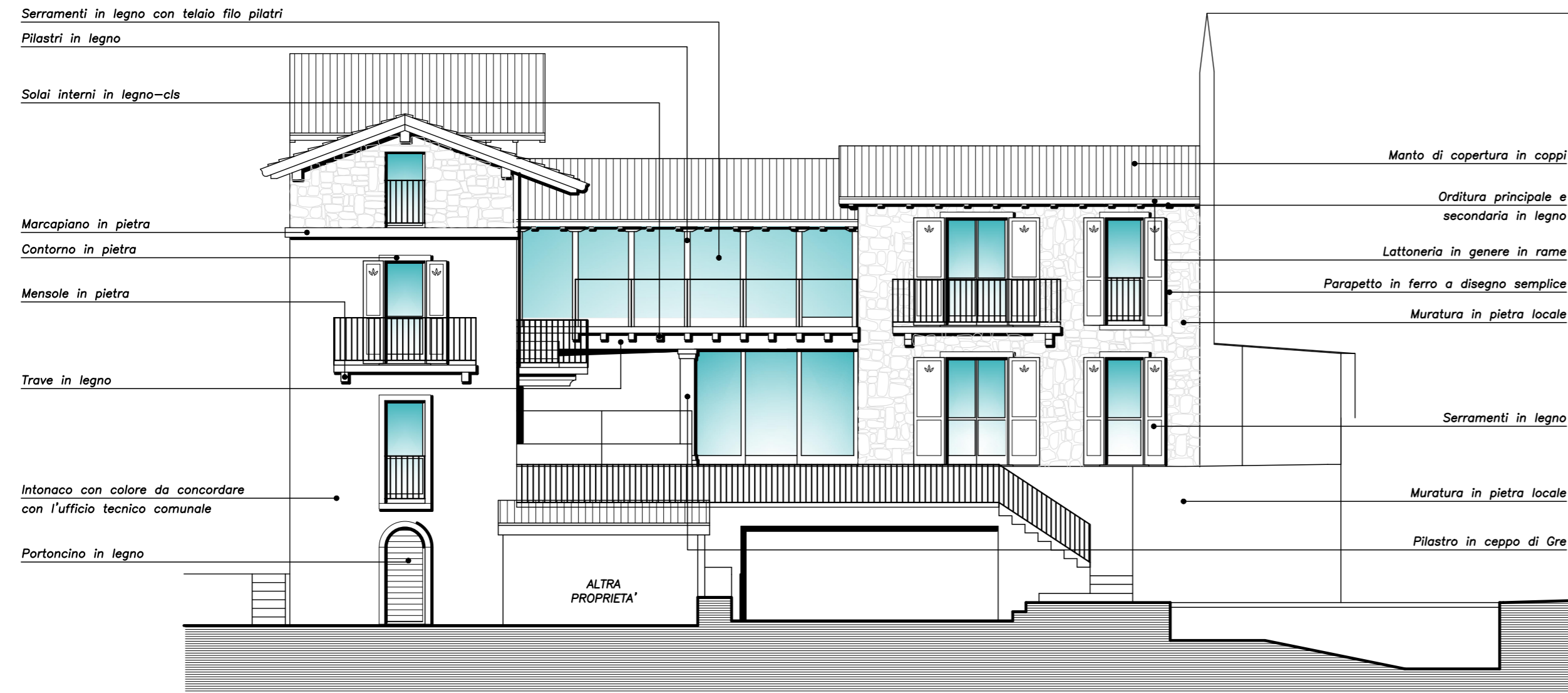
PROSPETTO SUD CON DESCRIZIONE MATERIALI SCALA 1:100
